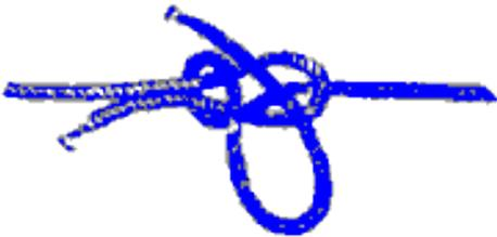
Este nudo es una variante del Vuelta de Escota que nos permite unir dos cuerdas de distinto grosor. Tiene una gaza corrediza que nos permite deshacerlo fácilmente con un tirón de la punta del extremo de la gaza.
