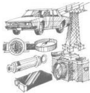
Como la aguja responde a cualquier campo magnético, al usarla, hay que cuidar que no esté cerca de objetos grandes de hierro como motores, automóviles, torres de conducción eléctrica, pilares o muros con varilla, etc. También hay que cuidar de no colocar cerca, hebillas, silbatos, plumas, encendedores, cámaras fotográficas o cadenas, que pueden afectar la operación correcta de la misma.
