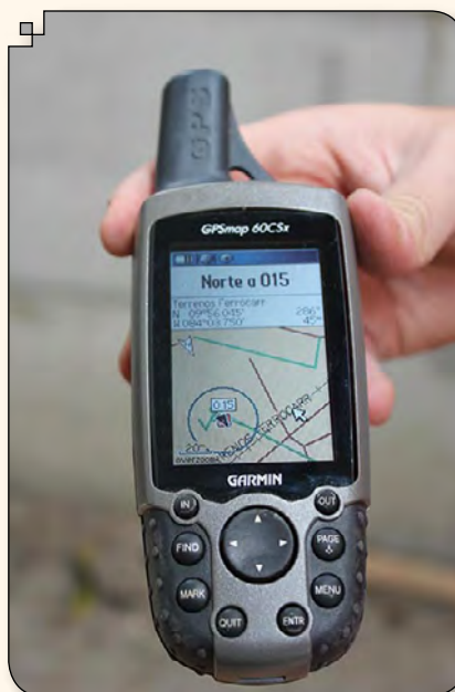
FOTOGRAFÍA 4. CREACIÓN DE TRAYECTO, MEDIANTE RECEPTOR GPS-GLONASS. Defina los lugares a visitar y active la función trayecto ( tracklog ) en el GPS para su ejecución
