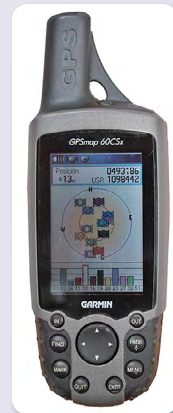
FOTOGRAFÍA 2. RECEPCIÓN DE SATÉLITES POR PARTE DEL GPS. La pantalla de satélites, muestra la señal que emite cada satélite al GPS y el grado de precisión que posee
