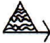
Agua no Potable
